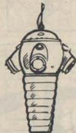
PER DIRIGERE I LAVORI SUBACQUEI SI IMPIEGANO LE TORRETTE BATOSCOPICHE AVENTI UNA STRUTTURA CAPACE DI RESISTERE ALLA PRESSIONE DI 30 ATMOSFERE (300 METRI DI PROFONDITA')
