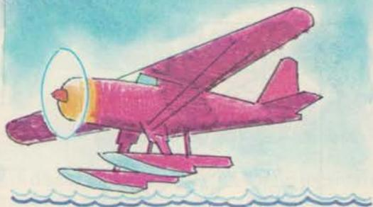
■ L'IDROVOLANTE è fornito di strutture atte a permettere il decollo e l'atterraggio sull'acqua. L'architettura più classica è quella a scafo centrale cigliato, come in un'imbarcazione, munito di uno o più gradini per consentire il distacco dall'acqua. Oggi l'idrovolante è quasi scomparso dopo essere stato un protagonista di primo piano nella storia del volo.
