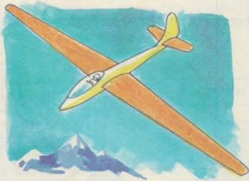
■ L'ALIANTE è un velivolo senza motore che si regge in aria sfruttando i giochi del vento (processo che fa volare gli aquiloni). Il tipo chiamato veleggiatore può volare anche a lungo sfruttando opportunamente correnti di aria ascendenti. È provvisto di freni speciali per atterrare in tempi brevi, ed è rimorchiato in volo da aeroplani e sganciato al momento opportuno.
