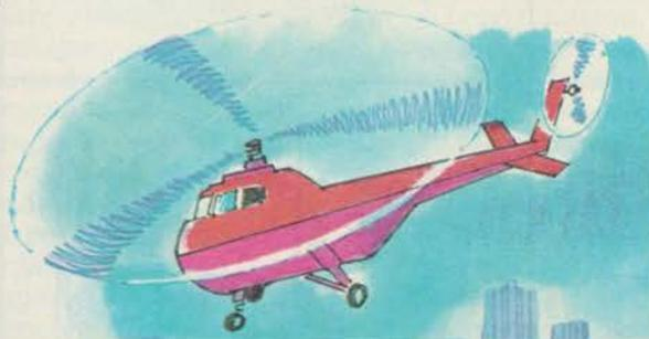
■ L'ELICOTTERO ha come caratteristica quella di salire o scendere verticalmente, fermarsi in aria, spostarsi lateralmente. Propulsione e sostentamento sono ottenute mediante uno o più rotori a pale, orientabili. È molto usato per salvataggi, esplorazioni, rifornimenti, trasporti di posta, disinfezioni agricole ecc. Già nel 1483 Leonardo da Vinci derivò dall'elica l'idea di una macchina costituita da una superficie elicoidale.
