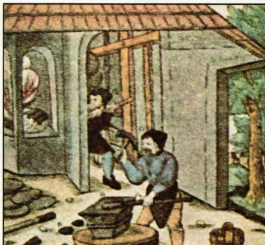
■ Un fabbro del 15° secolo: i mantici, azionati a mano, erano essenziali per forgiare il ferro.
