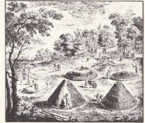
□ Produzione del carbone di legna (XVIII secolo). Prima dell'avvento del carbon fossile, il legno forniva quasi tutta l'energia termica necessaria. A fianco, spaccato di una miniera di carbone del XVI secolo.
